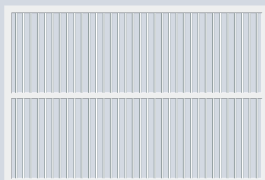
Motiv 470 Ispuna aluminijskim šipkama dimenzija 20 x 20 x 2 mm
